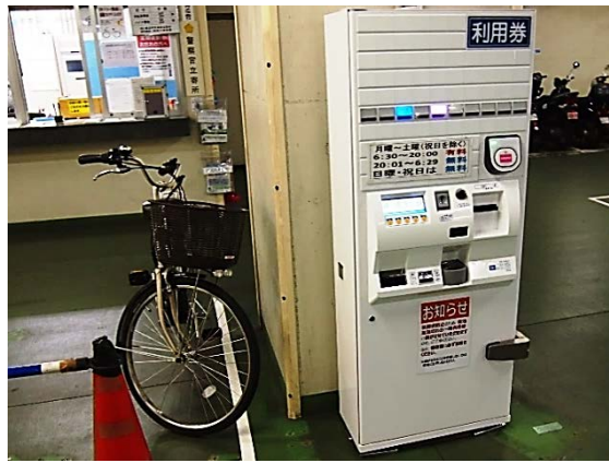
交通系 I Cカード対応一時利用券売機（中田駅自転車駐車場）
